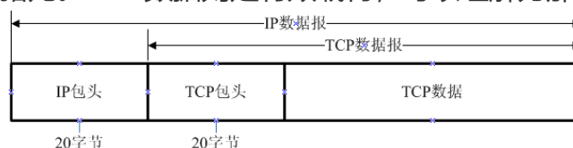
【图四 TCP 数据在 IP 数据报中的封装】
