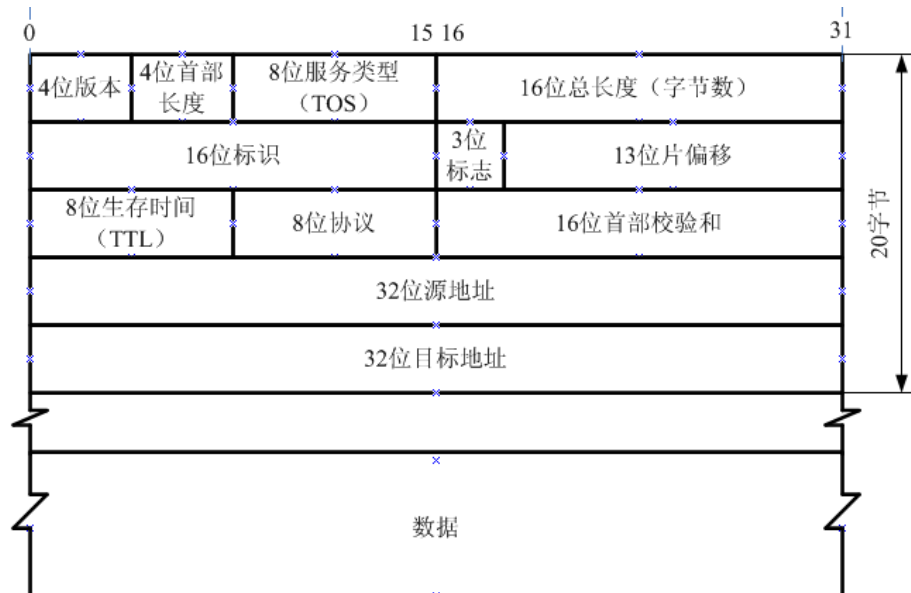
【图五 IP 数据报格式及首部中的各字段】
